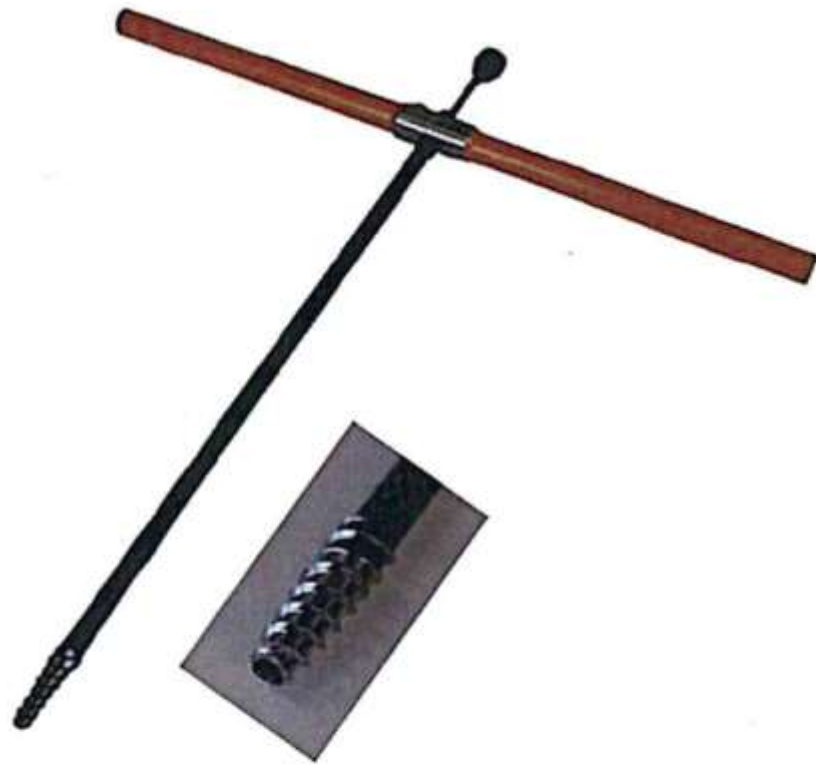
Abbildung 1: Zuwachsbohrer für die Entnahme von Proben an lebendem und totem Holz. Vergrößerung der Bohrerspitze unten.
